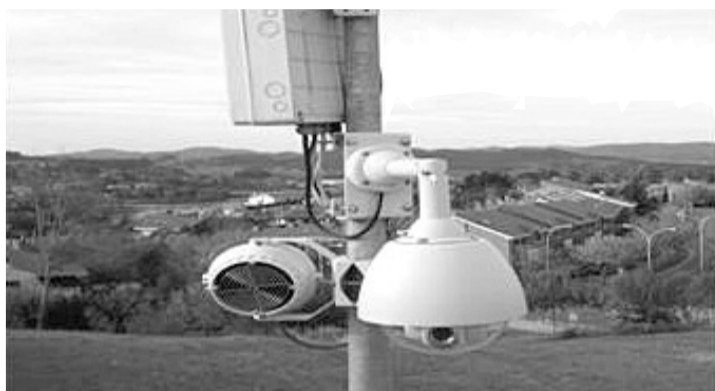
CÁMARA CON ANTENA WIFI Y FOCO DE INFRARROJOS INSTALADA EN UNA URBANIZACIÓN
